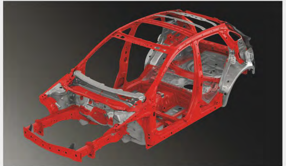
KAROSSERIE: LEICHTE UND HOCHFESTE STRUKTUR FÜR HOHE CRASH-SICHERHEIT UND AGILES HANDLING
